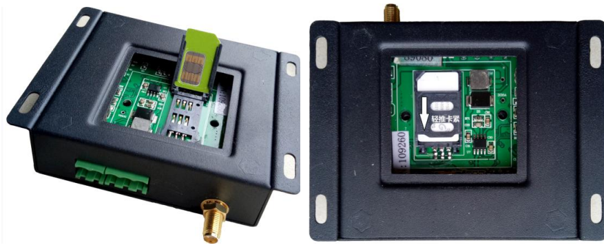
图 1-5 HY101N 数据采集器安装 SIM 卡
