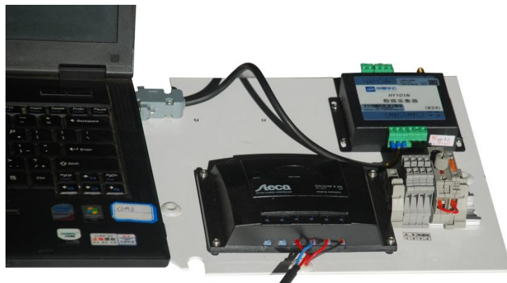
图 1-9 连接 HY101N 数据采集器调试线
