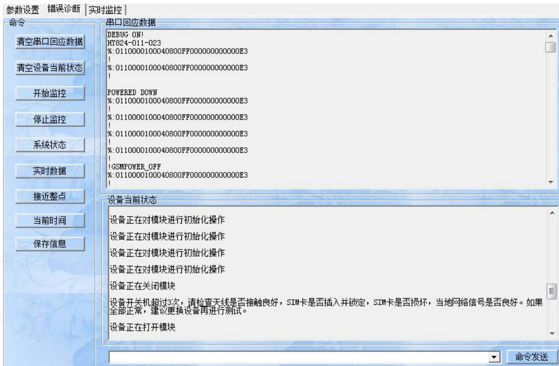
图 5-58 数据采集器无法登陆数据中心站
